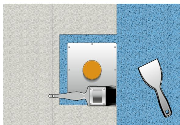
**SV** Montera FF System Folie 1-K / 2-K och överlappa hela manschetten. Tryck noga ut folien och säkerställ så att inga blåsor eller veck uppstår. Använd plastspackel. Förslut samtliga skarvar runt manschetten med FF M1 Membran alt. FF M-2K.
