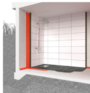
BILD A – Källare med tillskjutande markfukt
